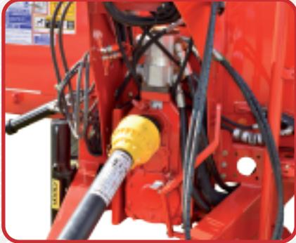
Accionamiento mediante toma de fuerza. Posee central hidráulica propia. No requiere conectar mangueras al tractor.
