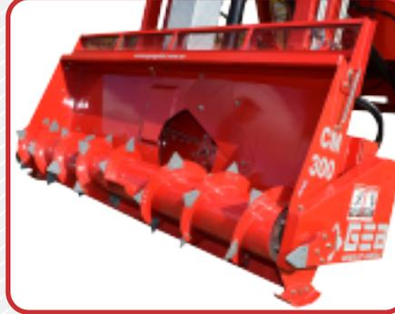
El sinfín con cuchillas cementadas y la potente turbina doble brindan agilidad a las labores de carga.
