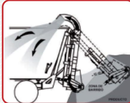
Un deflector dinámico en el extremo de descarga permite una distribución pareja del material.
