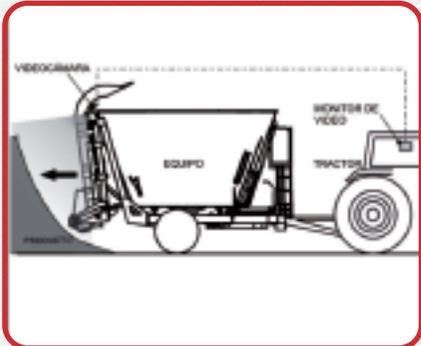
El sistema de video proyecta la imagen en tiempo real sobre la trayectoria y distancia del material.
