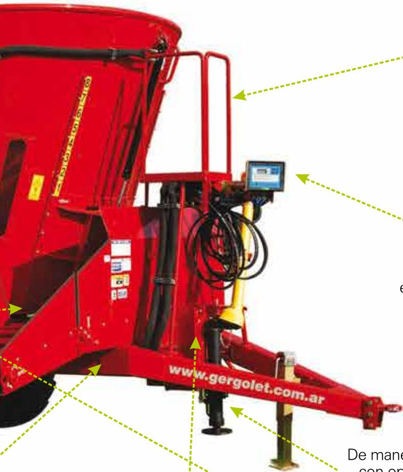
Provisto de escalera, plataforma y ventanas para un correcto monitoreo del proceso de mezclado.
