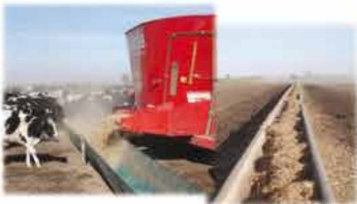
Descarga pareja por medio de acarreador regulable en altura y en velocidad.
