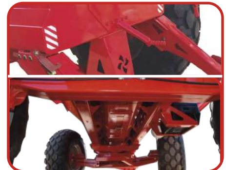
Comando de descarga inferior unificado. Piso cambiabile atornillado.
